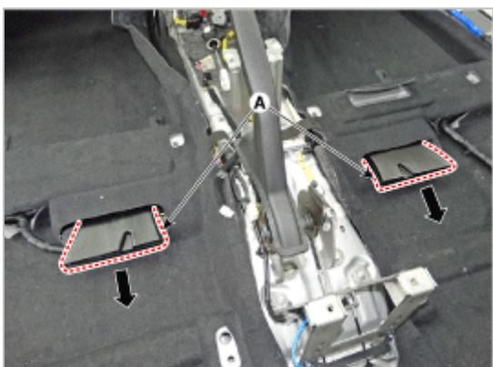
18. 拆卸地毯(A)以获取空间拆卸后暖风导管。
