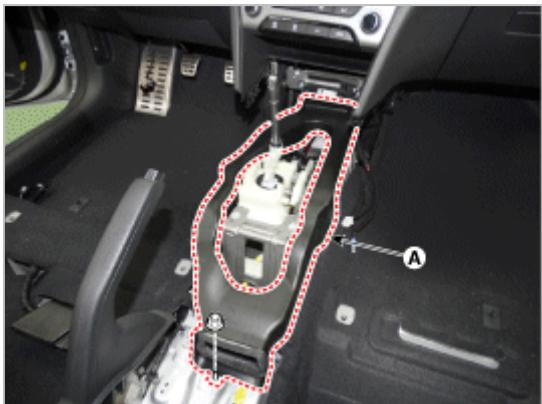
16. 分离空气囊控制模块(SRSCM)连接器(A)。
