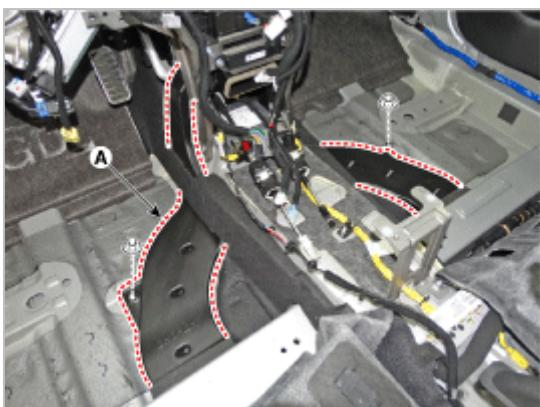
20. 分离连接器(A)，并拆卸前立柱上线束固定夹。
