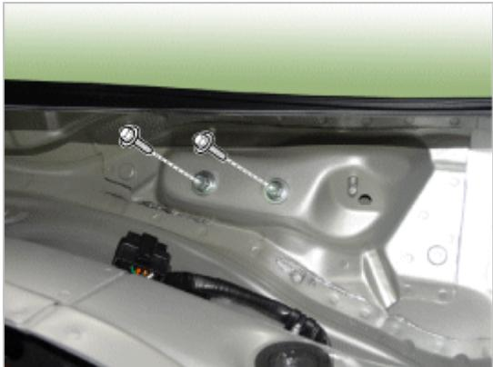
15. 拧下固定螺母，并拆卸中央控制台导管(A)。
